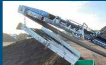
Magnetrollen – für die Eisenabscheidung am Abwurfband
