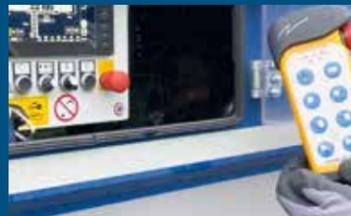
Funkfernbedienung – Zur Steuerung aus dem Radlader
