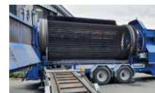
Einfacher Trommelwechsel mit Trommeldurchmessern bis 2.000 mm
