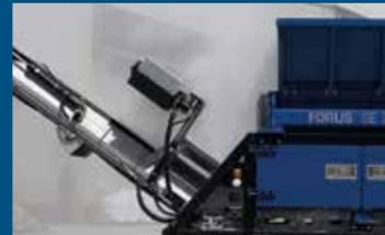
Hydraulisch höhenverstellbarer Neodymmagnetabscheider
