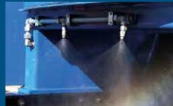
Materialbefeuchtungseinrichtung - zur Eindämmung von Staub
