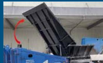
Trichterautomatik (FORUS) - für die automatische Beschickungsoptimierung
