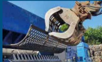
TEUTON: Siebkorbssystem - zur Erzeugung eines fertigen Endkorns
