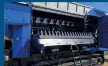
Zerkleinerungsklappe - hydraulisch ausschwenkbar = freier Zugang Zerkleinerungsbereich
