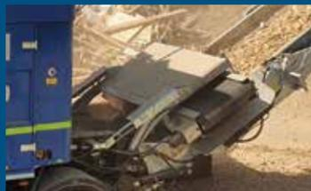
Starker Neodym Magnetabscheider, hydraulisch höhenverstellbar, beidseitiger Schrottabwurf
